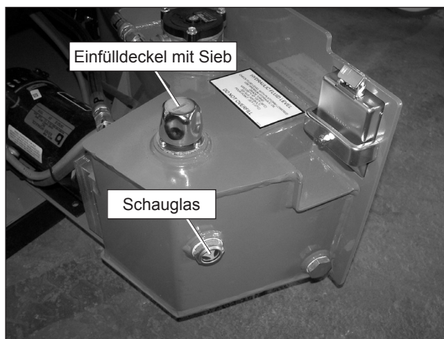
Abbildung 7 – Tank mit Hydraulikflüssigkeit
